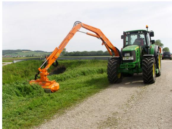
Tilteinrichtung zum Mähen mit Auslage des Mähgerätes nach vorne
